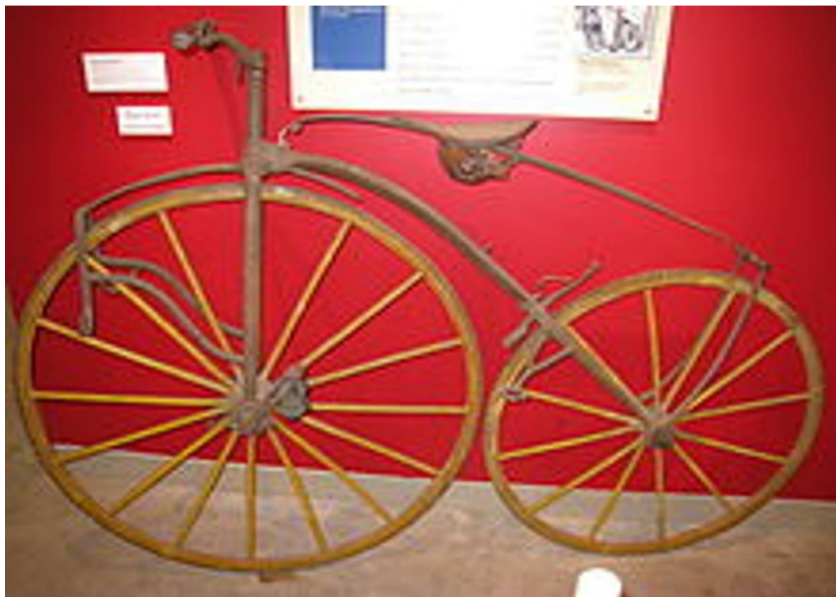
Bilde 2: Michauxs Velociped fra 1868 med smijernsramme, krank, pedal og bremseplate. Jernbeslåtte trehjul rista fælt på veg med brustein, humper, dumper og andre ujevnheter. Derfor ble den kalt «Knokkelrister» («Bone shaker»). https://commons.wikimedia.org/wiki/File:Boneshaker,_European,_circa_1868.JPG
